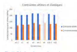
Fig 10. Résultats des tests de traction sur matériel soudé
